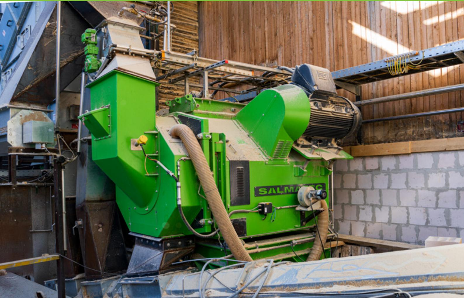
Wie bei allen SALMATEC-Anlagen kommen auch hier modernste Technologien zum Einsatz. Die neue Strukturmühle MaxiMill sorgt für ein besonders homogenes Ausgangsmaterial und reduziert zugleich den Stromverbrauch.
