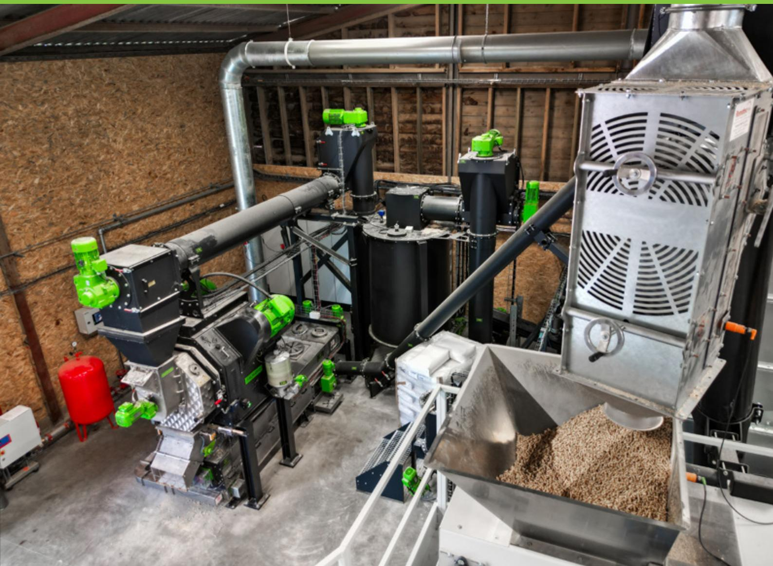
Aus unterschiedlichen Arten von Weichholz produziert der französische Kleinbetrieb nun ca. eine Tonne Holzpellets pro Stunde. Dieser Brennstoff wird lokal und regional vertrieben, um Pelletheizungen und -kamine zu befeuern.
