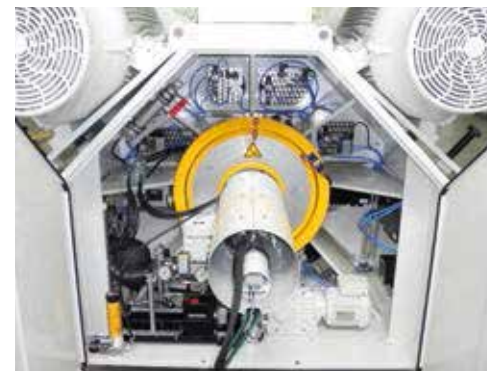
Автоматическая система регулировки зазора 3-х прессующих валцов
