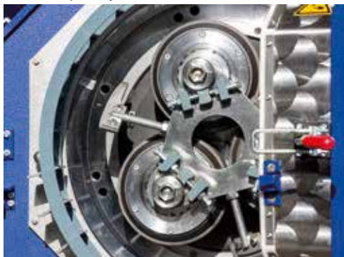
Многофункциональный нож / система из 3-х прессующих валцов
